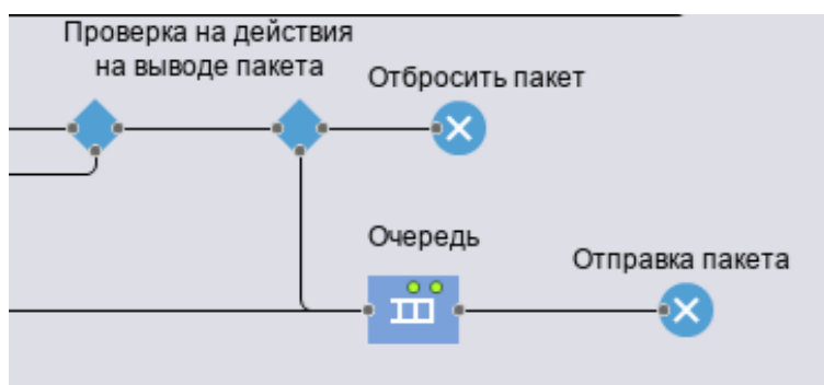
Рис. 5. Узел проверки действий над пакетами
