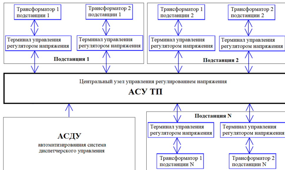
Рис. 1. Структурная схема автоматизированной системы регулирования выходных напряжений трансформаторов подстанций
